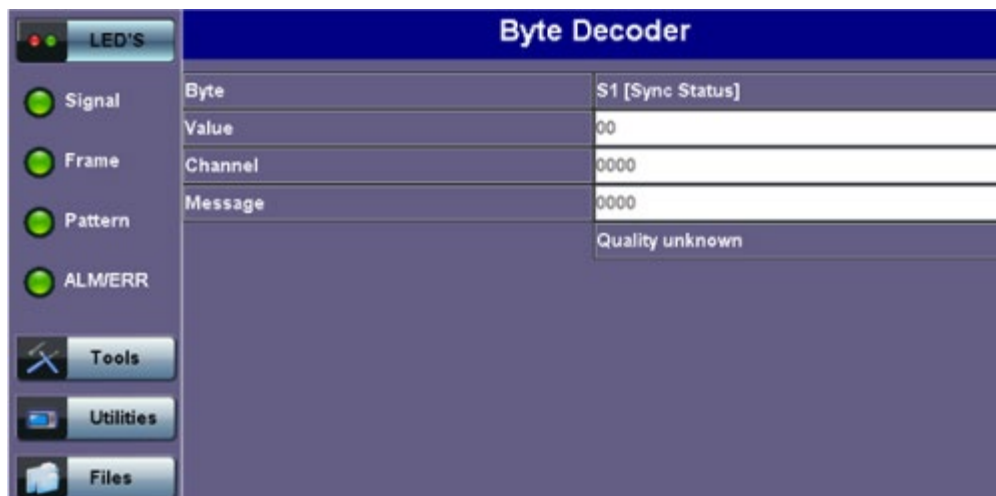
S1 Byte (Synchronization Status)
